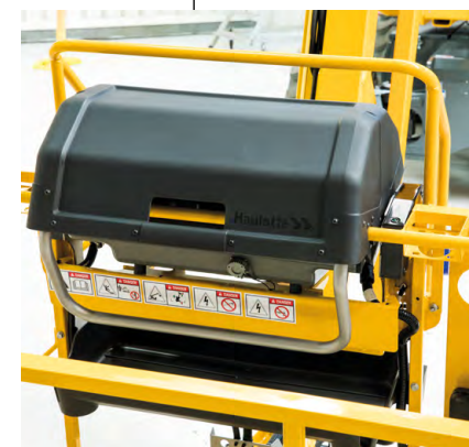
Защитный кожух панели управления из высокопрочного композитного материала
