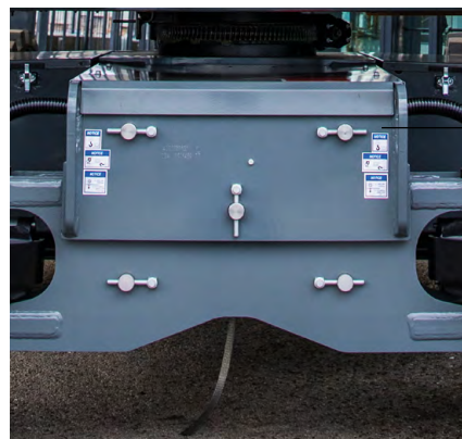
Направляющие цилиндры, защищенные внутри рамы
