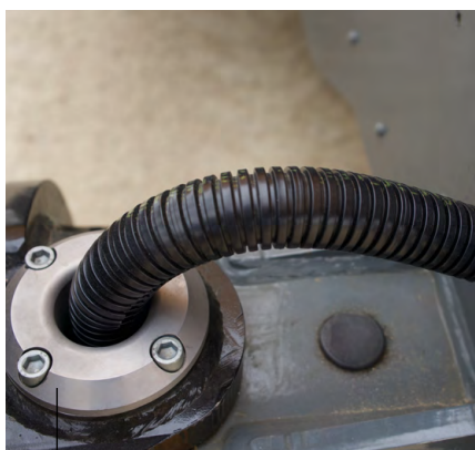
Отличная защита наиболее открытых электрических кабелей
